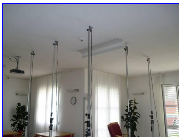
Foto 2: Sensori per rilevare le deformazioni
