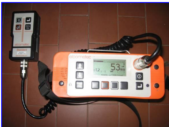
Foto 21: Strumentazione pachometrica utilizzata per l'individuazione delle armature
